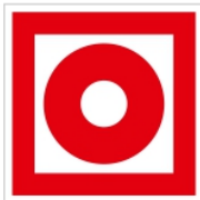
F 10 Кнопка включения установок (систем) пожарной автоматики
