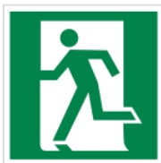
Е 01-01 Выход здесь (левосторонний)
